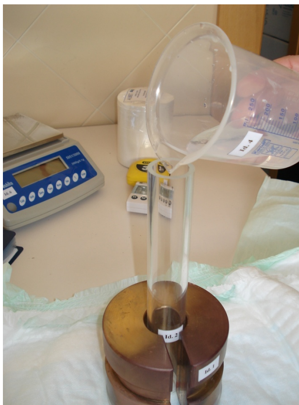
Imagen 2. Probeta, peso circular, vaso de precipitado con solución NaCl, absorbente, balanza electrónica, papel de filtro Albet, cinta métrica y cronómetro digital
